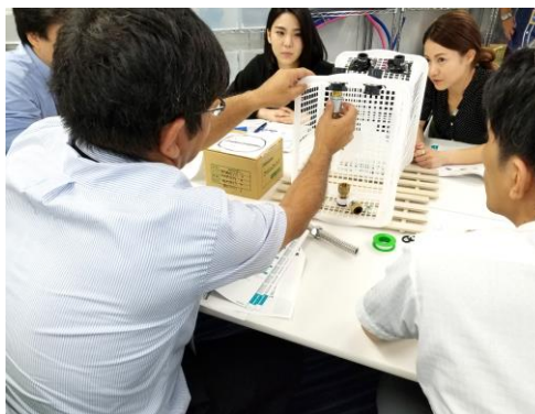
ネジ同士をそのまま接続できないものには、ニップルを使用して接続
